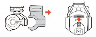
Schritt 1) Entfernen Sie die Sicherung vom hinteren Teil des CGO2-GB durch vorsichtiges Zurückziehen
