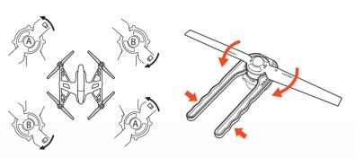
Jeder Motor und Propeller ist mit "A" oder "B" gekennzeichnet um eine einfache Installation an den richtigen Positionen zu gewährleisten (Installieren Sie Propeller mit "A" auf Motoren mit "A" und bei "B" genauso).
